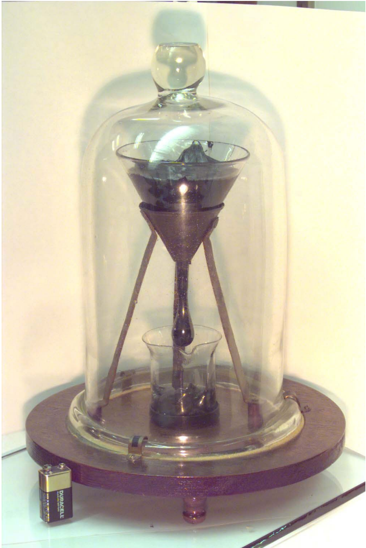
Bild: Pectropfenexperiment an der University of Queensland (Brisbane, Australien) mit einer 9V-Blockbatterie als Größenvergleich Quelle: John Mainstone, University of Queensland
